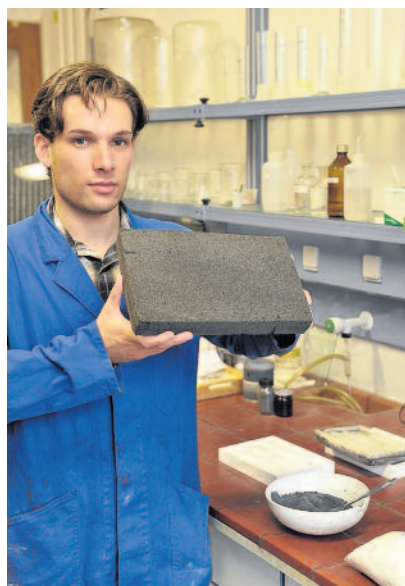
Marc Lüpfer präsentiert hier ein Stück des neuen Schaumglases, das zur Dämmung verwendet werden kann. Foto: E. Mildner
