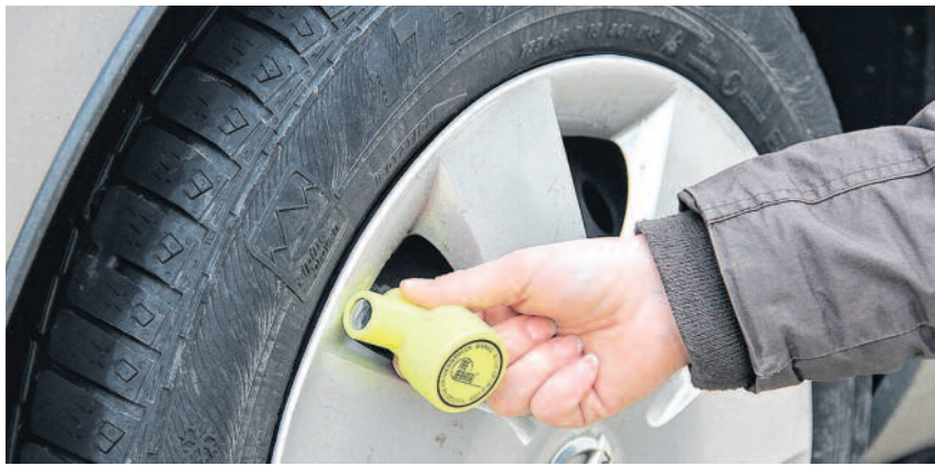
Klein aber sehr wirkungsvoll: die Ventilwächter. Sie lassen nach nur wenigen Metern Fahrt die Luft aus den Rädern.
