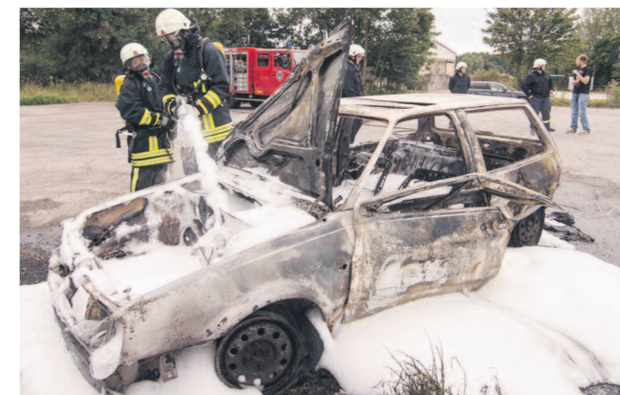
So sieht effektive Brandlöschung aus: Mit sogenanntem Löschschaum bekämpfen zwei Kameraden den Brand eines Fahrzeugs. Fotos (4): Feuerwehr
