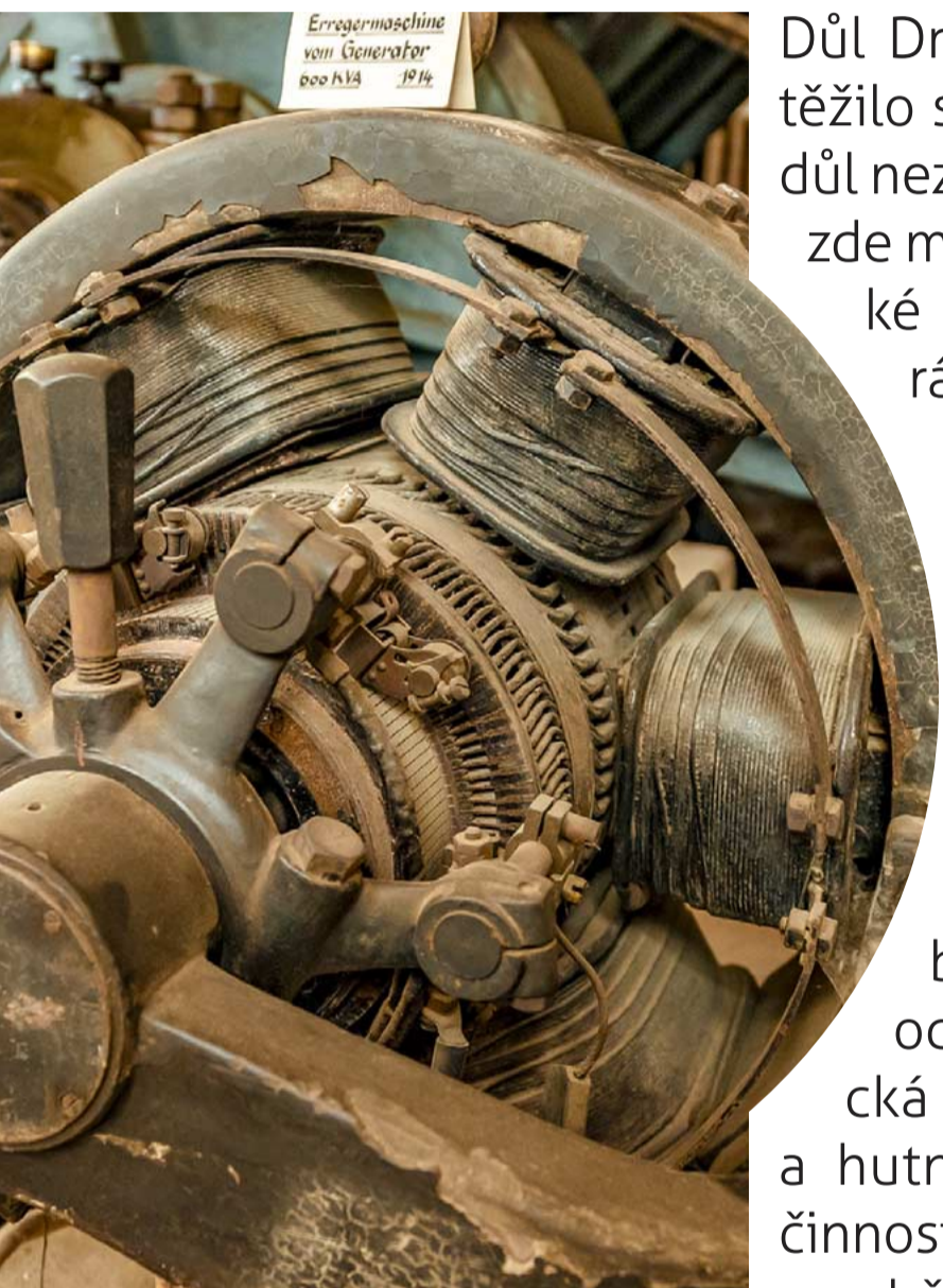
Foto nahoře: Generátor stejnosměrného proudu pro vytváření magnetického pole v třífázovém generátoru
