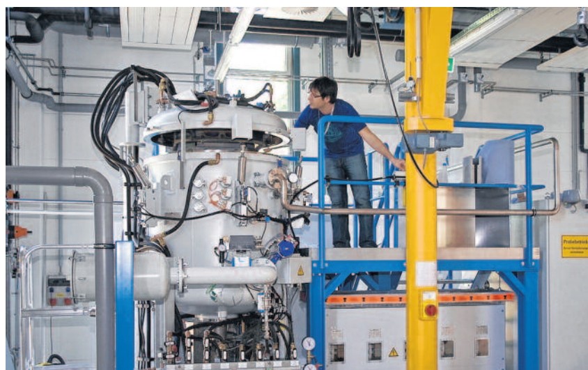
G1-Kristallisationsanlage zur Optimierung von Silizium-Halbleitermaterialien am neuen Technikum des Fraunhofer THM in Freiberg. Bild: Fraunhofer THM
